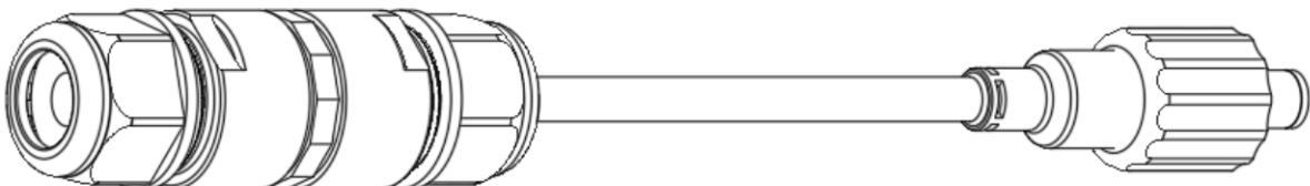
**KORAK 3.** Umetnите kabel i spojite ga kako je prikazano na slici. **Napajanje je osjetljivo na polaritet, pa budite oprezni pri spajanju kabela na adapter i konektor.** Održavajte isti polaritet na konektoru i adapteru.
